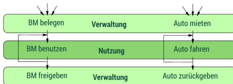
Abbildung 8.1: Klammerung der Nutzung eines Betriebsmittels durch Verwaltungsoperationen
